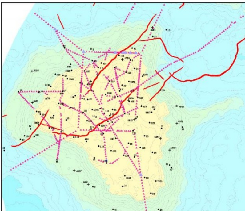
Рис. 17. Схема профильных линий повторных наблюдений (нивелировка) на месторождении Тенгиз (количество реперов 1420, общая протяженность профильных линий 400 км) [1]
